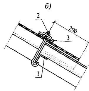
1 – прогон; 2 – крепежный элемент типа «крюк»; 3 – шайба
