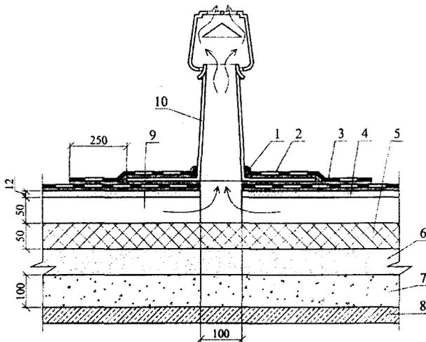
1 – герметик; 2 – дополнительный слой водоизоляционного ковра; 3 – основной слой ковра; 4 – сборная стяжка из ЦСП; 5 – минераловатные плиты; 6 – монолитная (существующая) стяжка; 7 – увлажненный пенобетон; 8 – железобетонная несущая плита; 9 – вентилируемый канал; 10 – аэратор Ø 100 мм
