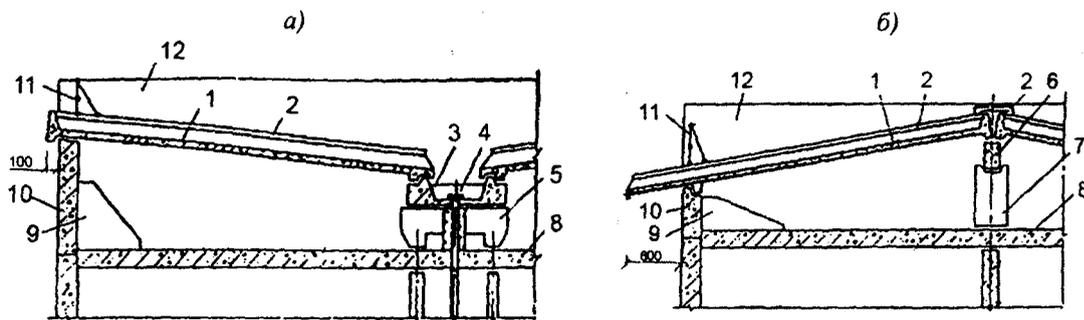
а – с внутренним водоотводом; б – с неорганизованным водоотводом; 1 – железобетонная кровельная панель; 2 – железобетонный П-образный нащельник; 3 – железобетонный водосборный лоток; 4 – водосточная воронка; 5 – подкладочная балка под лоток; 6 – опорная балка; 7 – опорный столик; 8 – утепленная панель перекрытия; 9 – треугольный анкерный элемент; 10 – опорная фризная панель; 11 – ограждение крыши; 12 – торцовая фризная панель
