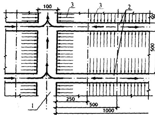
1 – вентилируемый канал; 2 – диффузионные каналы; 3 – движение влаги
