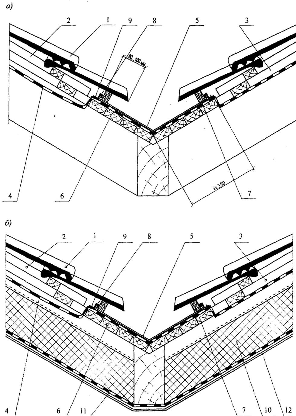
1 – черепица; 2 – обрешетка; 3 – контробрешетка; 4 – гидрозащитная пленка; 5 – алюминиевый окрашенный желобок; 6 – сплошной дощатый настил ендовы; 7 – поролоновая полоса; 8 – скоба крепления желоба; 9 – оцинкованный гвоздь; 10 – утеплитель с покровным (ветрозащитным) слоем; 11 – пароизоляция; 12 – внутренняя обшивка
