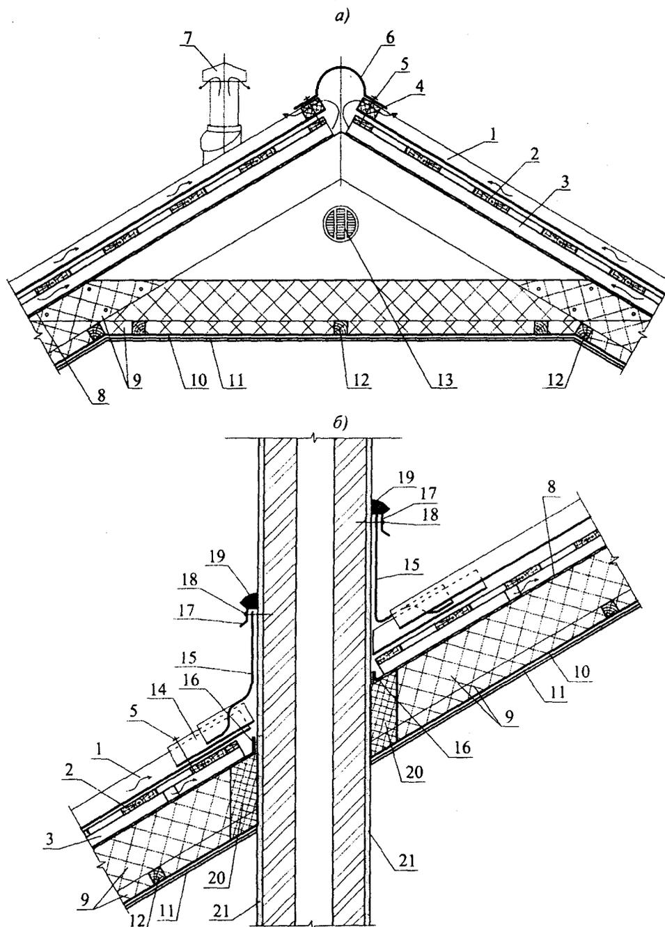
1 – волнистый лист; 2 – обрешетка; 3 – контробрешетка; 4 – уплотнитель без вентиляционных отверстий; 5 – гвоздь с закрывающейся шляпкой; 6 – коньковый элемент; 7 – венттруба; 8 – ветро-гидрозащитная пленка; 9 – теплоизоляция; 10 – пароизоляция; 11 – гипсокартон; 12 – брусок; 13 – щипцовое окно; 14 – фартук; 15 – вертикальная часть фартука; 16 – герметизирующая лента; 17 – металлическая планка; 18 – дюбель; 19 – герметик; 20 – минвата (негорючая); 21 – кирпичная труба
