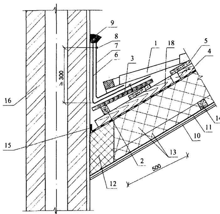
1 – металлочерепица; 2 – брусок; 3 – деревянный настил; 4 – контробрешетка; 5 – обрешетка; 6 – битумный самоклеящийся рулонный материал; 7 – металлическая деталь; 8 – дюбель; 9 – герметик; 10 – гипсокартон; 11 – пароизоляция; 12 – минвата (негорючая); 13 – теплоизоляция; 14 – брусок; 15 – крепление ветрогидрозащитной пленки двухсторонней липкой лентой; 16 – труба; 18 – ветрогидроизоляционная пленка; 18а – ветрозащитный слой (из стеклохолста); 19 – гидрозащитная пленка
