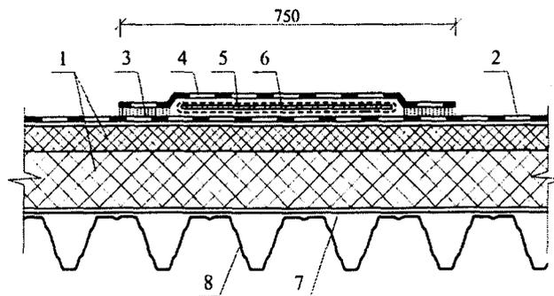
1 – плитный утеплитель; 2 – основной водоизоляционный ковер из ПВХ- или ТПО-мембраны; 3 – сварной шов шириной 30 мм; 4 – дополнительный слой водоизоляционного ковра из ПВХ- или ТПО-мембраны; 5 – защитный слой из геотекстиля плотностью не менее 350 г/м<sup>2</sup>; 6 – влагостойкая антисептированная фанера толщиной 12 мм; 7 – пароизоляция; 8 – несущий профнастил
