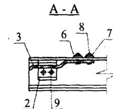
1 – накрываемый край волнистого листа; 2, 3 – скоба; 4 – лотковая деталь; 5 – край волнистого листа; 6, 7 – шайбы; 8 – винт с полукруглой головкой; 9 – заклепка
