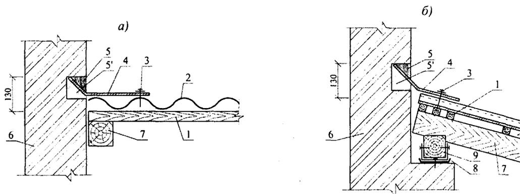
1 – обрешетка; 2 – лист; 3 – гвоздь (шуруп); 4 – угловая деталь; 5 – герметик; 5' – цементно-песчаный раствор; 6 – стена; 7 – стропило; 8 – гидроизоляция из рулонного материала; 9 – мауэрлат
