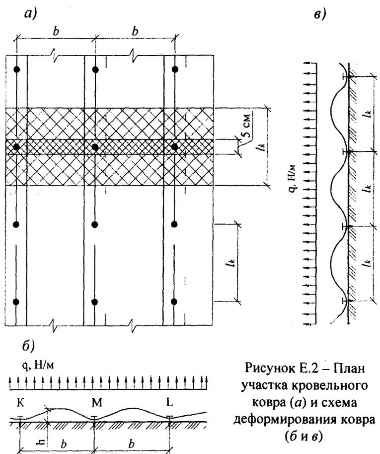
Рисунок Е.2 – План участка кровельного ковра (а) и схема деформирования ковра (б и в)
