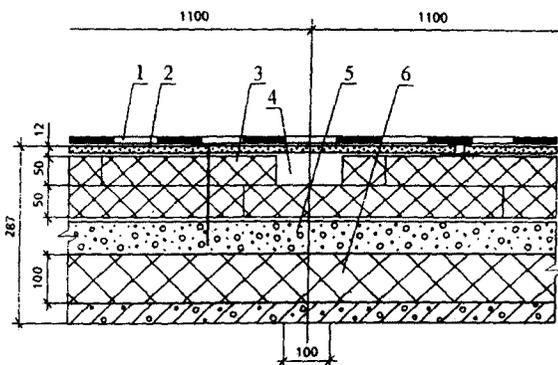
1 – новый кровельный ковер; 2 – сборная стяжка из ЦСП; 3 – минераловатные плиты; 4 – вентилируемые каналы; 5 – существующая стяжка из цементно-песчаного раствора; 6 – увлажненный пенобетон
