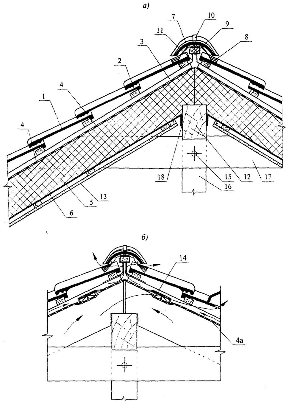
1 – черепица; 2 – обрешетка; 3 – контробрешетка; 4 – ветрогидрозащитная пленка; 4а – гидрозащитная пленка; 5 – утеплитель; 6 – пароизоляция; 7 – коньковая черепица; 8 – аэрозлемент конька; 9 – коньковый брус; 10 – зажим коньковой черепицы; 11 – крепление конькового бруса; 12 – коньковый прогон; 13 – внутренняя обшивка; 14 – вентиляционный элемент; 15 – болтовое соединение; 16 – столб; 17 – ригель; 18 – приклейка пароизоляции
