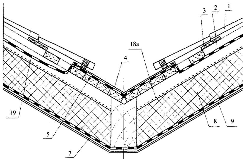
1 – металлочерепица; 2 – контробрешетка; 3 – обрешетка; 4 – лист водоотводящего желоба; 5 – сплошной настил; 6 – гидроизоляционная пленка; 7 – пароизоляция; 8 – теплоизоляция; 9 – гипсокартон
