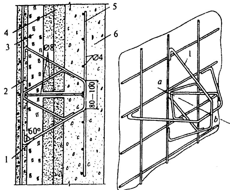
1 – пространственный анкер; 2 – железобетонная несущая плита; 3 – минераловатная изоляция;
