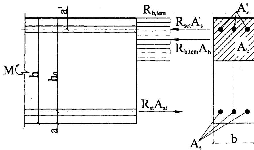
Рисунок 7.2 – Схема усилий и эпюра напряжений в сечении, нормальному к продольной оси изгибающегося железобетонного элемента, при расчете его по прочности
