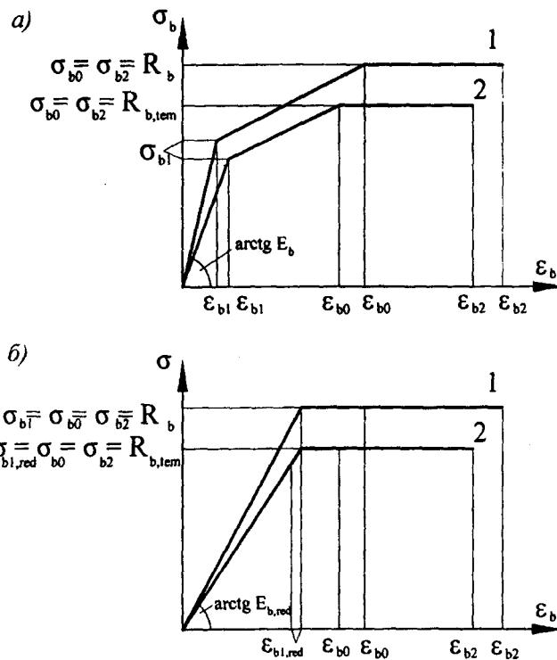
а – трехлинейная; б – двухлинейная; 1 – при 20 °C; 2 – при нагреве
