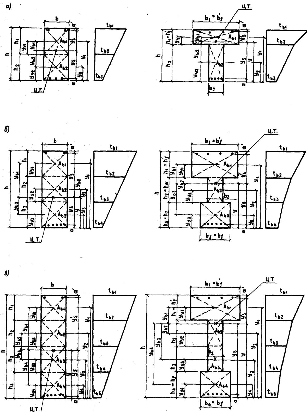
*a* – на 2 части; *b* – на 3 части; *c* – на 4 части; Ц.Т. – центр тяжести приведенного сечения;
