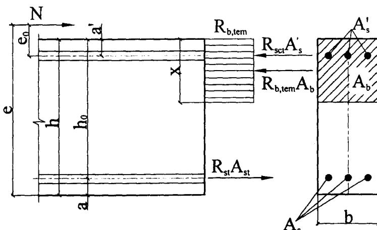
Рисунок 7.4 – Схема усилий и эпюра напряжений в сечении, нормальному к продольной оси внецентренно сжатого железобетонного элемента, при расчете его по прочности
