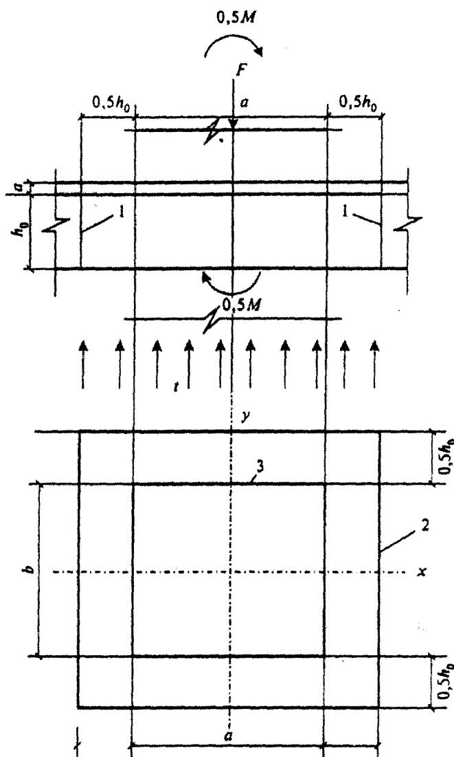
1 – расчетное поперечное сечение; 2 – контур расчетного поперечного сечения;
