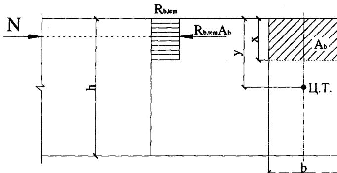
**Рисунок 7.1 – Схема усилий и эпюра напряжений в сечении, нормальном к продольной оси внерадиально сжатого бетонного элемента, рассчитываемого без учета сопротивления бетона растянутой зоны**
