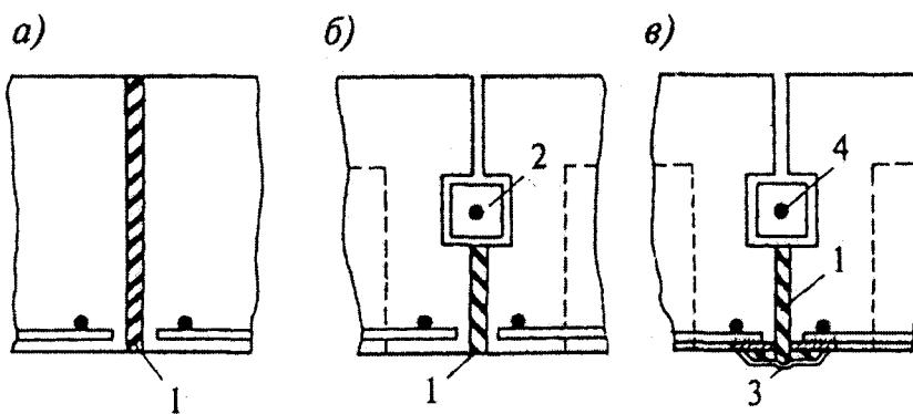
а – шов, заполненный шнурковым асбестом; б – то же, с бетонным бруском; в – то же, с металлическим компенсатором; 1 – шнурковый асбест, смоченный в глиняном растворе; 2 – бетонный бруск; 3 – компенсатор; 4 – стальной стержень диаметром 6 мм
