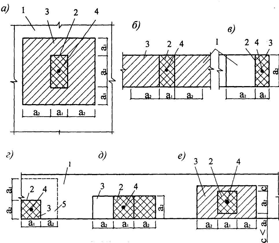
*a* – вдали от краев элемента; *б* – по всей ширине элемента; *в* – у края (торца) элемента по всей его ширине; *г* – на углу элемента; *д* – у одного края элемента; *е* – вблизи одного края элемента; 1 – элемент, на который действует местная нагрузка; 2 – площадь смятия  $A_{b,loc}$ ; 3 – максимальная расчетная площадь  $A_{b,max}$ ; 4 – центр тяжести площадей  $A_{b,loc}$  и  $A_{b,max}$ ; 5 – минимальная зона армирования сетками, при которой косвенное армирование учитывается в расчете
