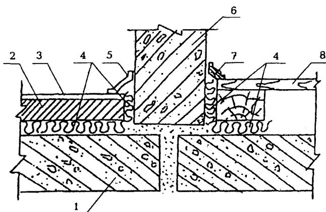
1 — несущая часть междуетажного перекрытия; 2 — бетонное основание пола; 3 — покрытие пола; 4 — прокладка (слой) из звукоизоляционного материала; 5 — гибкий пластмассовый плинтус; 6 — стена; 7 — деревянная галтель; 8 — дощатый пол на лагах
